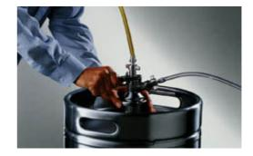
Mit einer Viertelumdrehung nach rechts rastet der Zapfkopf ein. Dann kann der schwarze Griff nach unten gedrückt werden, bis auch dieser einrastet.
